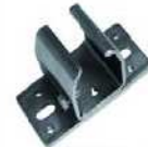
SOPORTE TECHO Ref. 16204 Piezas para fijar el rail a estructuras en el techo. Se colocarán cada 1,6 metros para configuración de 1 usuario y cada 1 metro en caso de configuración para 2 usuarios simultáneamente. Fabricado en acero D13 zincado.
