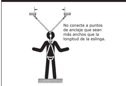
Conexión de una eslinga para auto-amarre: Vea la Figura 14. Pase la eslinga para auto-amarre por la estructura de anclaje. Asegúrese de que la eslinga no esté torcida. Regule el anillo en D flotante de modo que caiga por debajo de la estructura de anclaje. Conecte el gancho del extremo de la eslinga al anillo en D flotante. Cuando use la eslinga, asegúrese de que esté bien apretada alrededor del anclaje.
