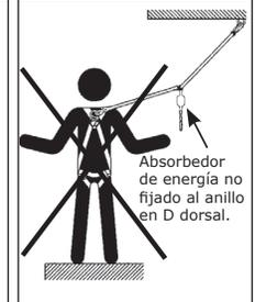
**Figura 10: Conexión incorrecta**
