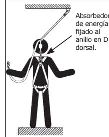
**Figura 9: Conexión incorrecta**
